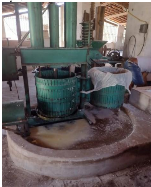
Figura 5. Prensa hidráulica da Casa de Farinha do Sítio Malhada.
