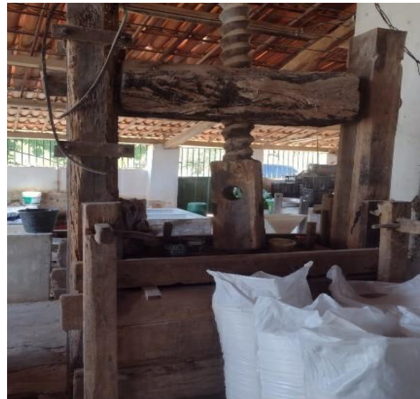
Figura 4. Antiga prensa de madeira da Casa de Farinha do Sítio Malhada.
