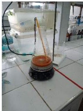
Figura 1: soluções de ferro (II e III). Figura 2: adição da biomassa
