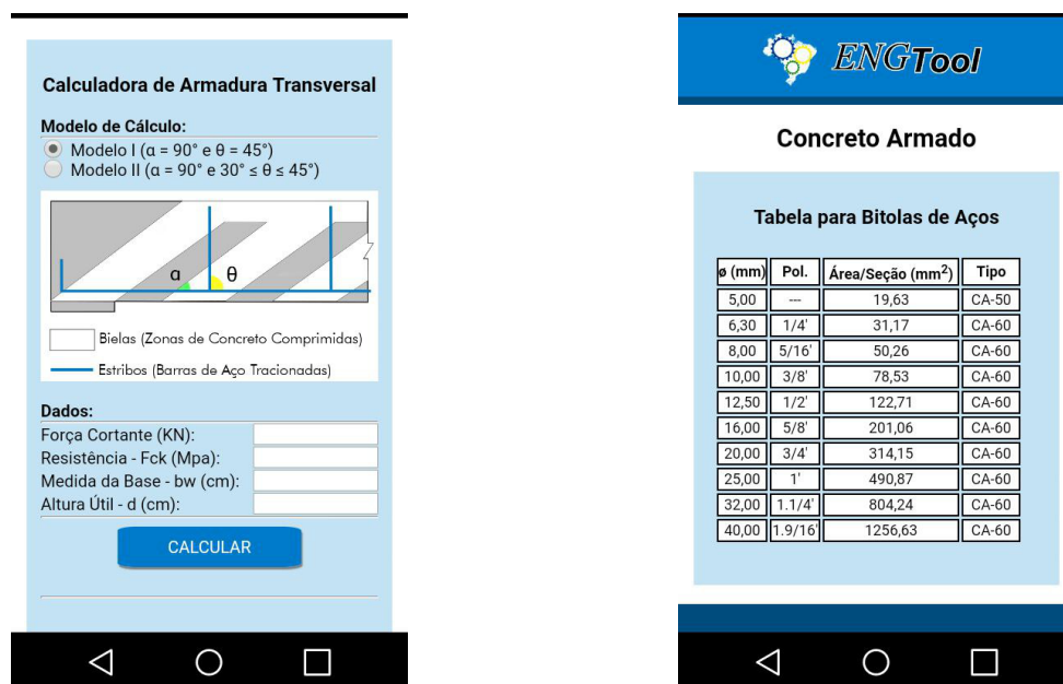
Figura 5 – Imagens da seção da armadura transversal e da seção de tabela de bitolas do aplicativo.
