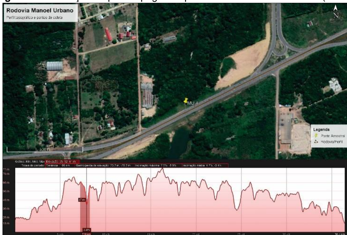
Figura 2: Construção do perfil topográfico para a rodovia Manoel Urbano (AM-070)
