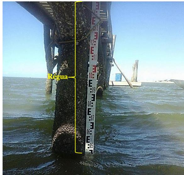
Figura 03. Medição da maré. Fonte: Autores (2017).
