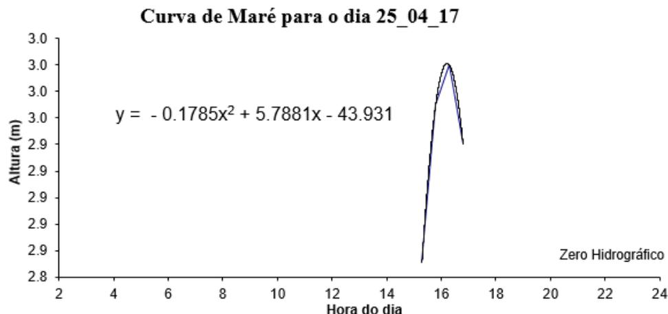
**Figura 04.** Equação da curva de Maré. **Fonte:** DHN (2017)
