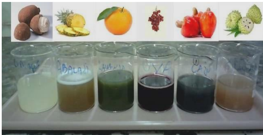
Figura 2 – Resultado final das soluções coloidais obtidas da mistura das polpas de frutas com a solução de nitrato de prata
