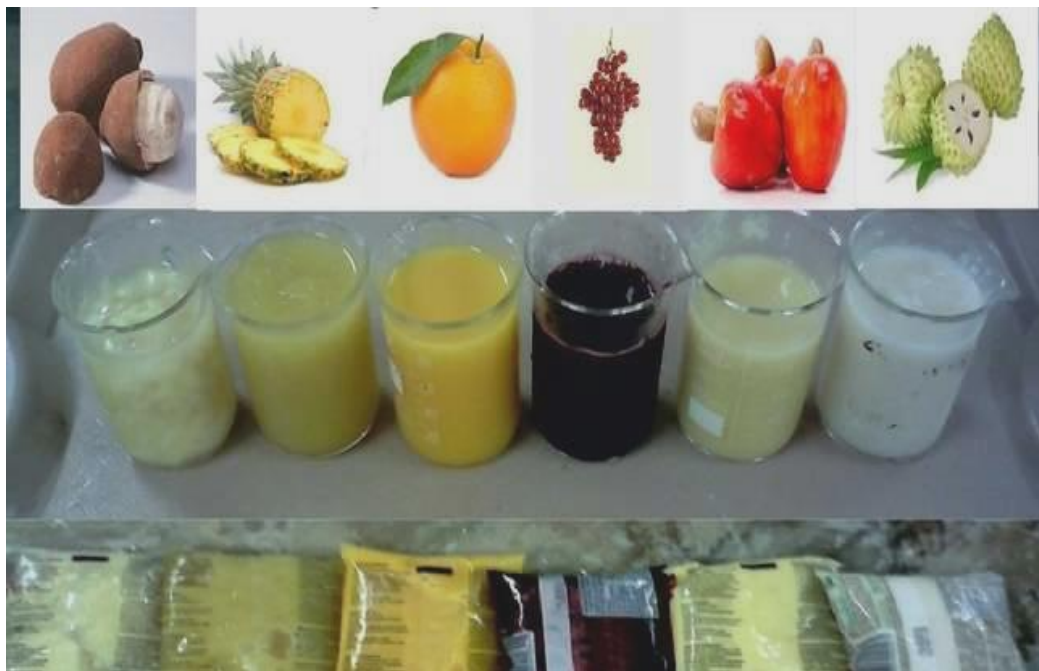
Figura 1 – Polpas de frutas utilizadas na síntese das nanopartículas de prata – da esquerda para direita: cupuaçu, abacaxi, laranja, uva, caju, graviola
