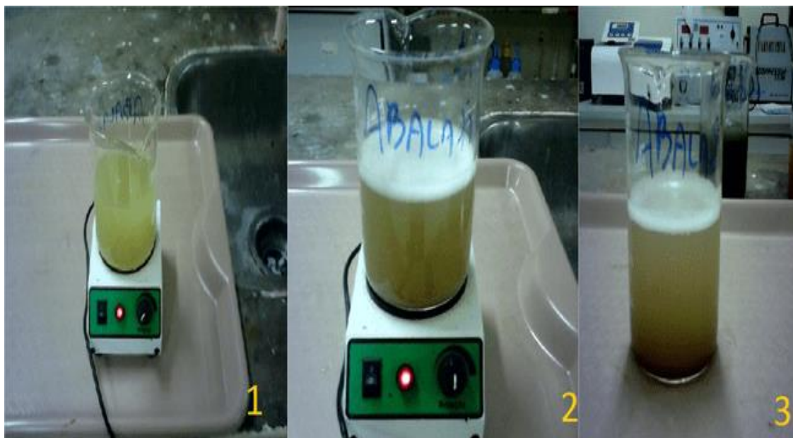
Figura 4 – Sequencia da formação de nanopartículas de prata a partir da polpa de abacaxi - (1) estado inicial (2) mudança de cor com o tempo da síntese (5-20 minutos) (3) estado final da síntese (1 hora depois)
